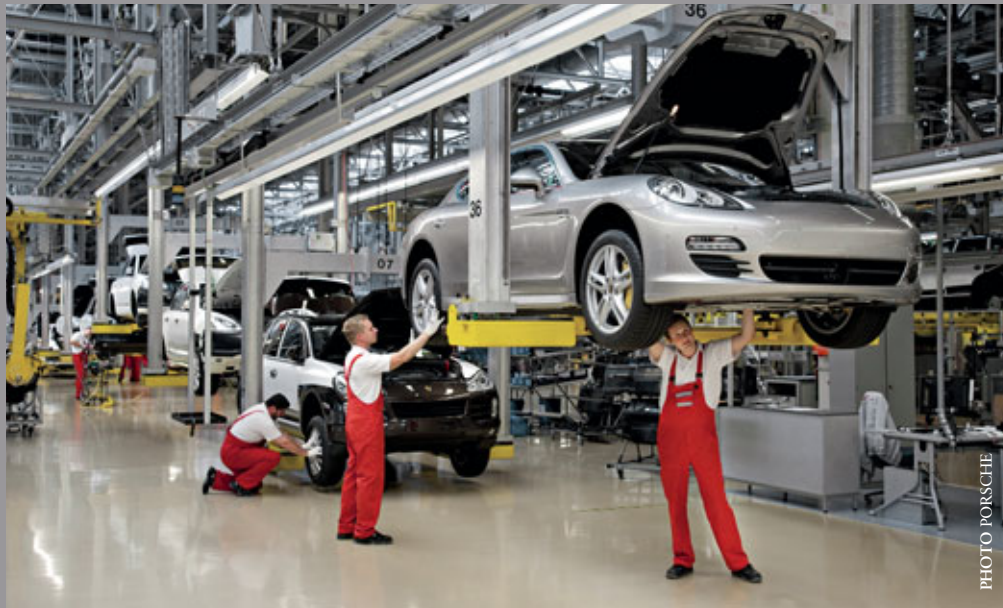
Einer nach dem anderen: Panamera und Cayenne werden im Werk Leipzig im Modell-Mix montiert
