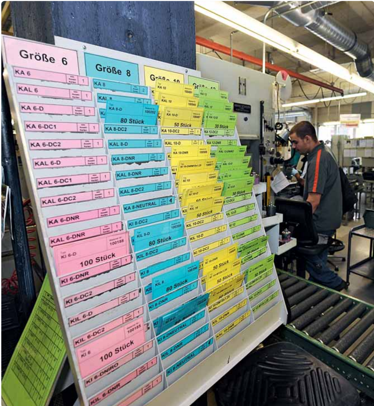
Beruhigte Fertigung: Die Produktionssteuerung basiert heute durchgehend auf dem sogenannten Zieh-Prinzip
