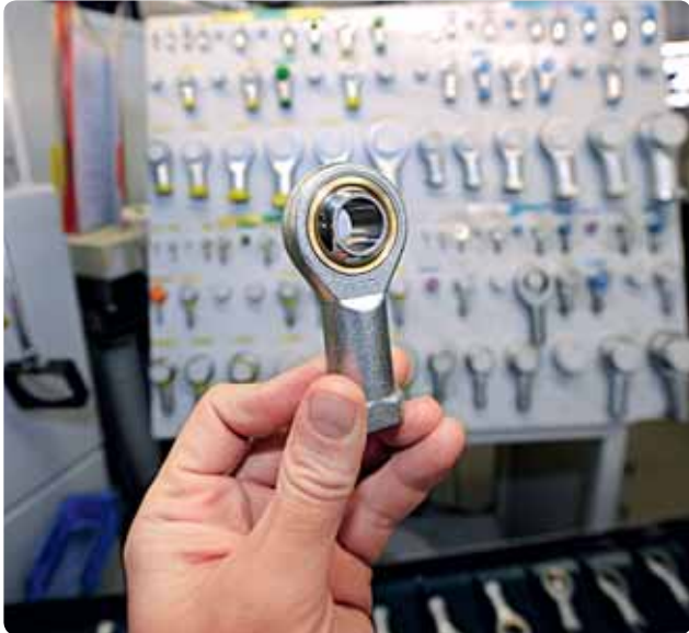
Gelenkkopf mit Gehäuse – die verschiedenen Größen und Mengen können zeitnah produziert und für den Kunden fertig gemacht werden
