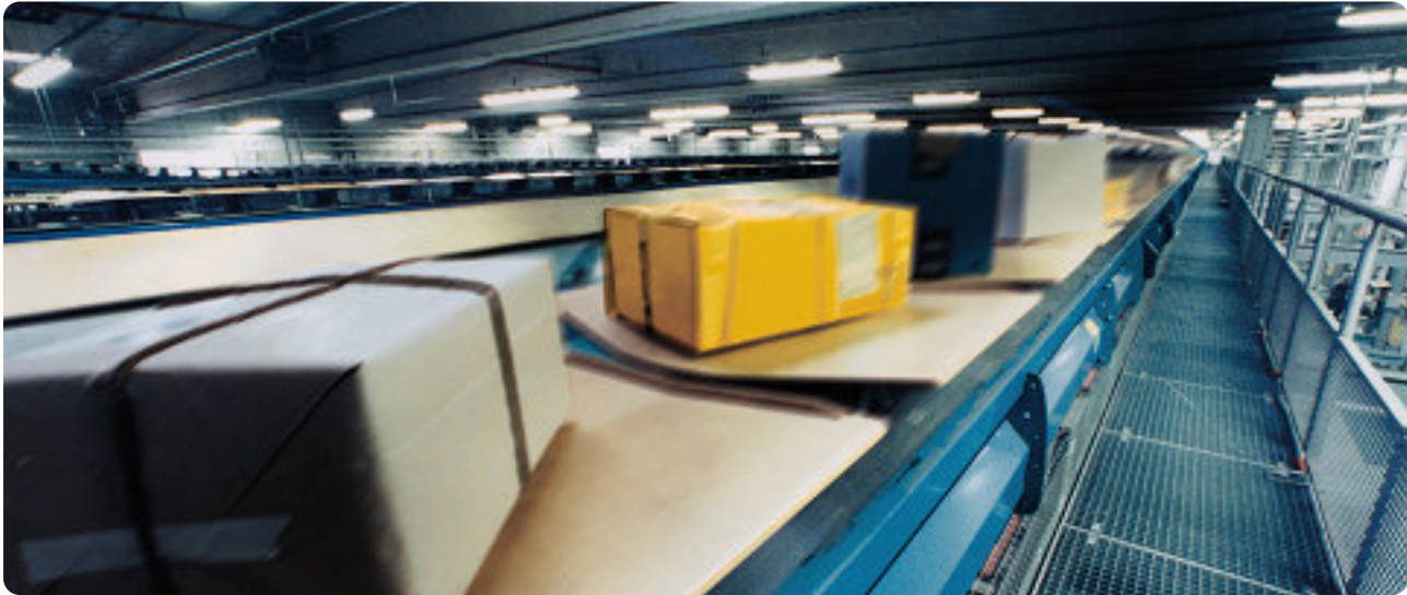
Fließender Verkehr: Transportbänder mit Kippschalen befördern die Paketsendungen bis zu den Endstellen der Paketzentren
