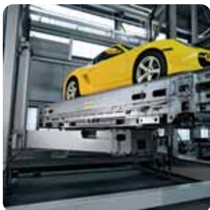
Einparken, wie es sonst unter Ausschluss der Öffentlichkeit geschieht: Das Wöhr-System bringt den Porsche automatisch in Position
