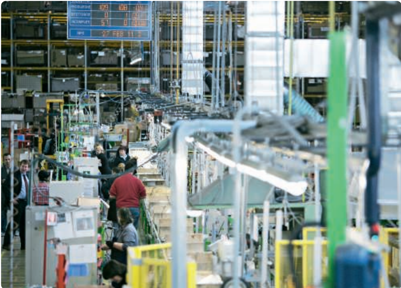
„Just in Time“-Prinzipien bei der Herd-Montage: Links wird gearbeitet, rechts stehen die kommissionierten Teile aus dem Supermarkt
