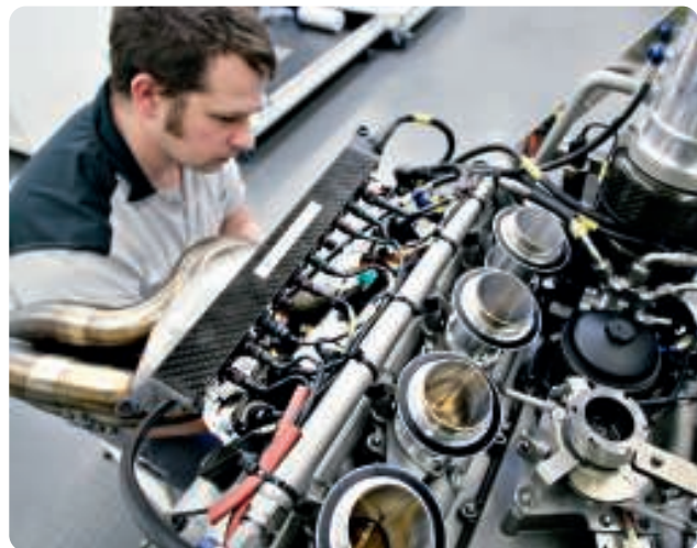
Motorenmontage: Perfekte Handarbeit mit 1400 Einzelteilen
