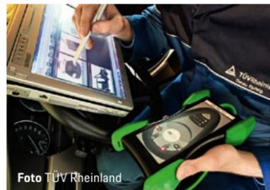
In Deutschland müssen Neuwagen alle drei Jahre, alle anderen Autos alle zwei Jahre zur Hauptuntersuchung. Dabei schließen die Prüfer von TÜV Rheinland auch einen Adapter an die On-Board-Diagnose-Schnittstelle eines Fahrzeugs an. Mit Laptop, Smartphone oder Tablet können sie dann auf digitale Fahrzeugdaten zugreifen und diese mit Angaben in einer zentralen Datenbank abgleichen.
