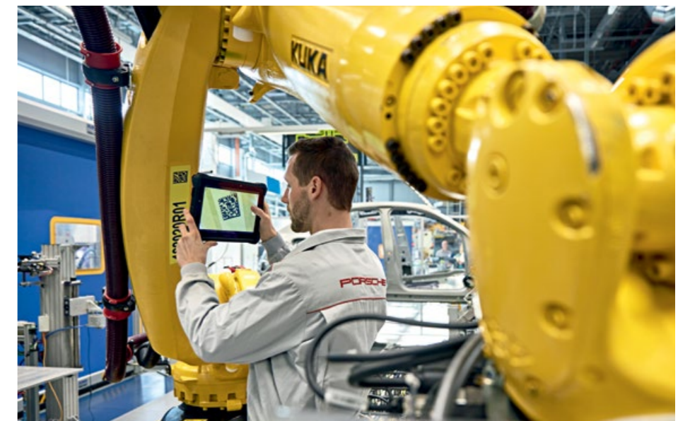
Die „Pfleger“ kennen ihre Roboter genau: Über einen DataMatrix-Code kann der Instandhalter anlagenbezogene Daten abrufen.
