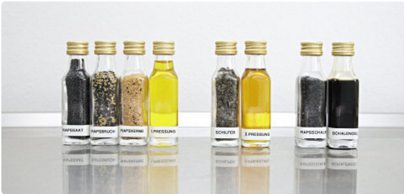
Vollverwertung in Flaschen: Links die vier Stufen zum Speiseöl – der Rest wird zu Tierfutter (M.) oder dient der Energieversorgung (r.)
