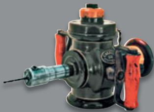
Die erste elektrische Handbohrmaschine der Welt wog 7,5 kg und hatte einen Bohrdurchmesser von vier Millimetern
