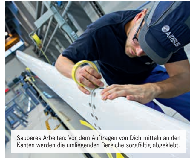
Die letzte Station der getakteten Flow Line: Mit der Montage und Abdichtung der Verkleidung wird das Leitwerk verschlossen.
