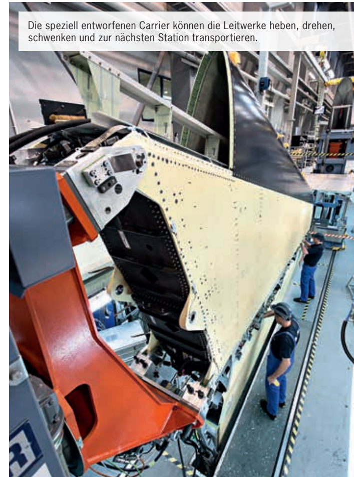
Geschulter Blick: Ein Mitarbeiter kontrolliert die Befestigung eines Aktuators, der elektrische Signale in mechanische Steuerung umwandelt.
