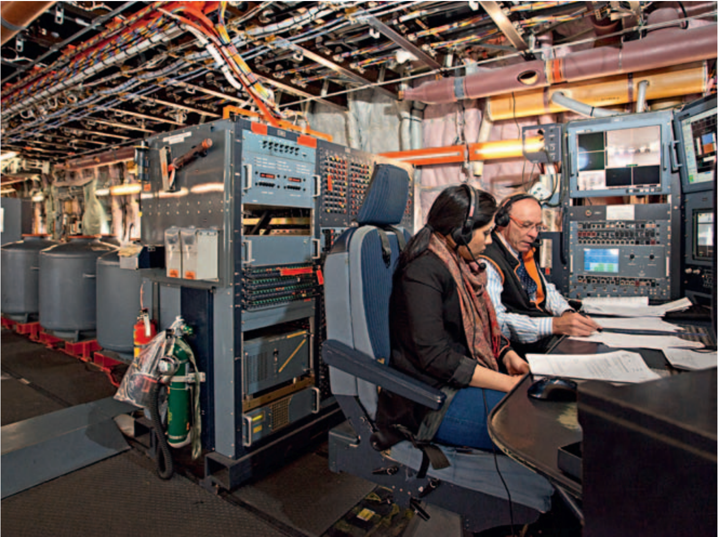
Am Kontrollplatz in der Kabine verarbeiten Test-Ingenieur Robert Lignéé und eine Mitarbeiterin Daten aus 6 000 Sensoren sowie die Bilder der Außenkameras.
