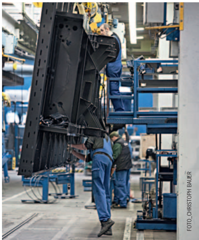
Senkrechtstarter: Die Stahlchassis der Sattelaufleger werden nach der Tauchlackierung für den individuellen Aufbau mit Kabelsträngen ausgerüstet.
