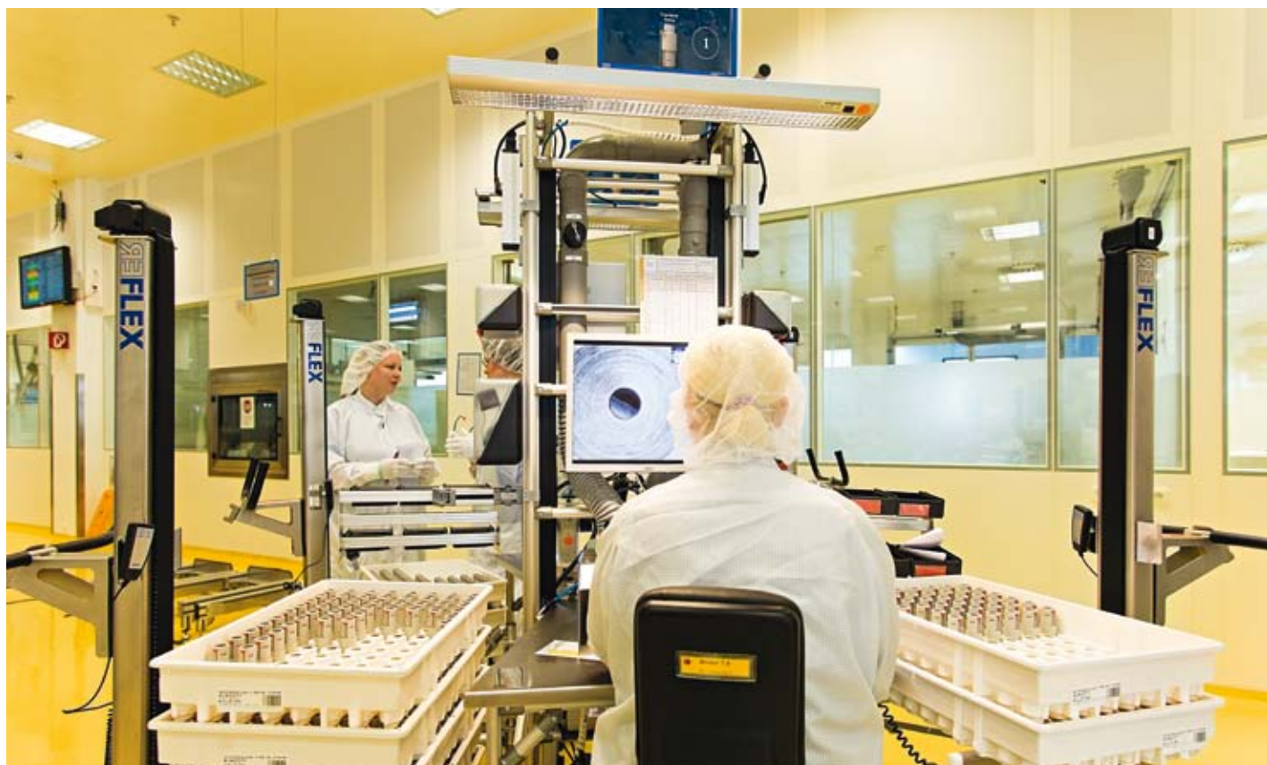
In der Endmontage werden die verschiedenen Module und Baugruppen zum Endprodukt, dem Inhalationsgerät RespiMat®, zusammengefügt.
